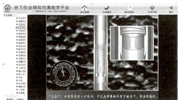
图1 卡瓦打捞筒工作原理
